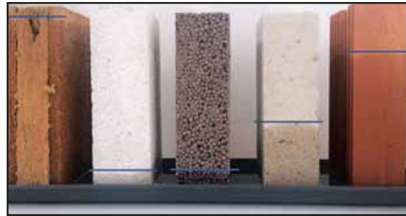
Abb. 3: Wasseraufnahmeverhalten verschiedener mineralischer Wandbaustoffe (© HTW Dresden)
